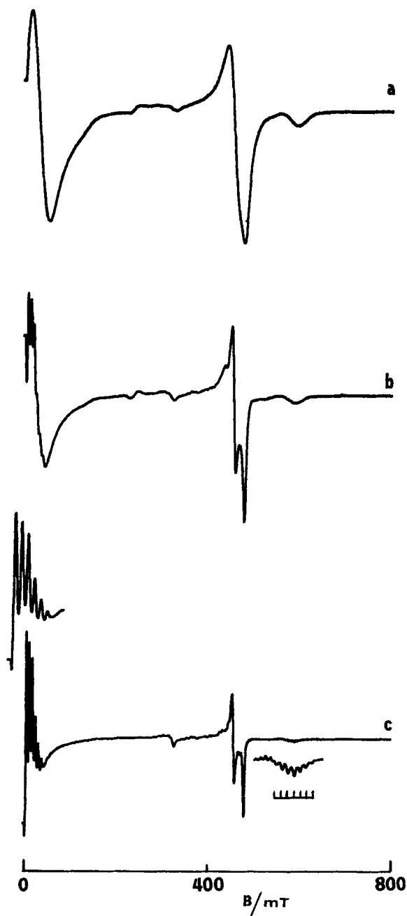
Figure 2 ESR spectra \text{Cu}(\text{CH}_3\text{COO})_2 \cdot \text{nia} \cdot 2\text{H}_2\text{O} at a—293 K, b—150 K, c—100 K.
